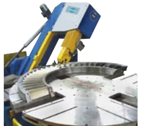
Classic 600 DGH - Spez. • für die Zerspanung von Turbinenringen • for the cutting of stator rings • pour le tronçonnage de bagues de turbine
