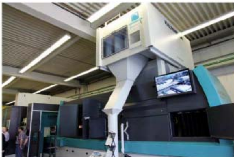
Kaltenbach Gietart sandblåsing satt i linje med rengjøringskabinett, lakkering og varmebehandling gir effektiv overflatebehandling av stål.
