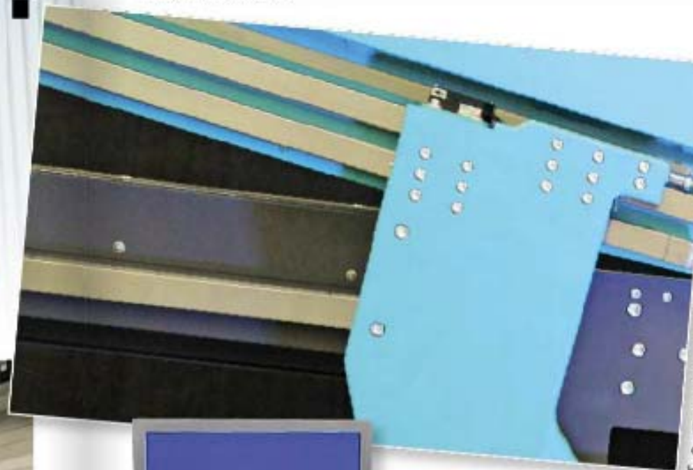
Kaltenbach modell KBS 1051 sager gjennom en h-bjelke i stål på 430x300 mm i løpet av 100 sekunder.
